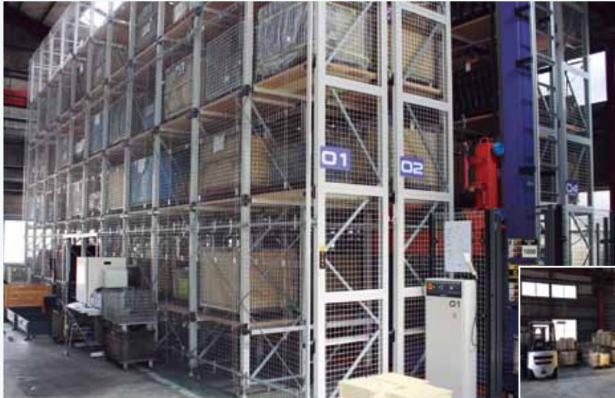
長さ18m×幅5m×高さ7m、格納数214パレットのCS。従来は平置き管理していた(写真右)。
